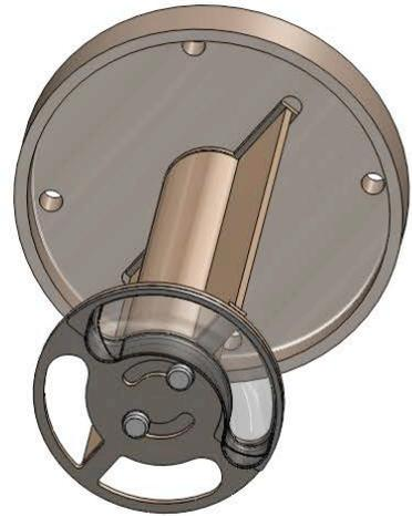
Gitterplatte gegen den Uhrzeigersinn drehen
