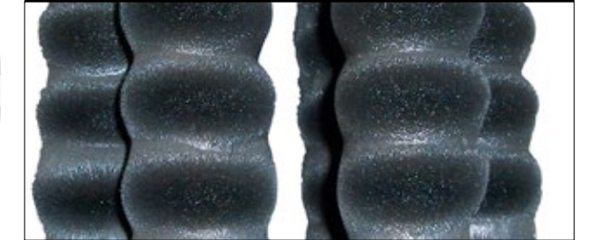
Verunreinigungen haften am 9.000-Gauß-Magnetkern
